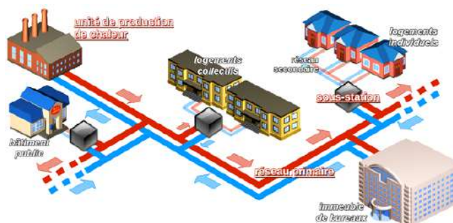
Synoptique d'un réseau de chaleur
